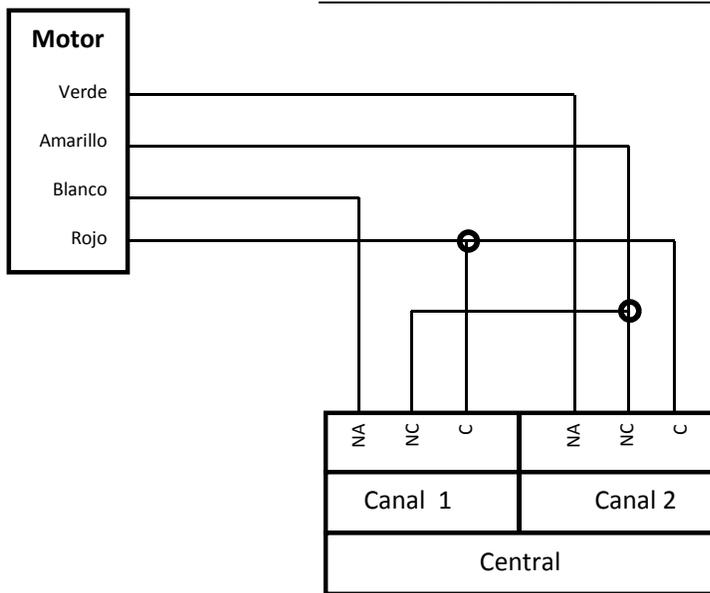
**Conexión de la Central únicamente (cable corto de mando):**
