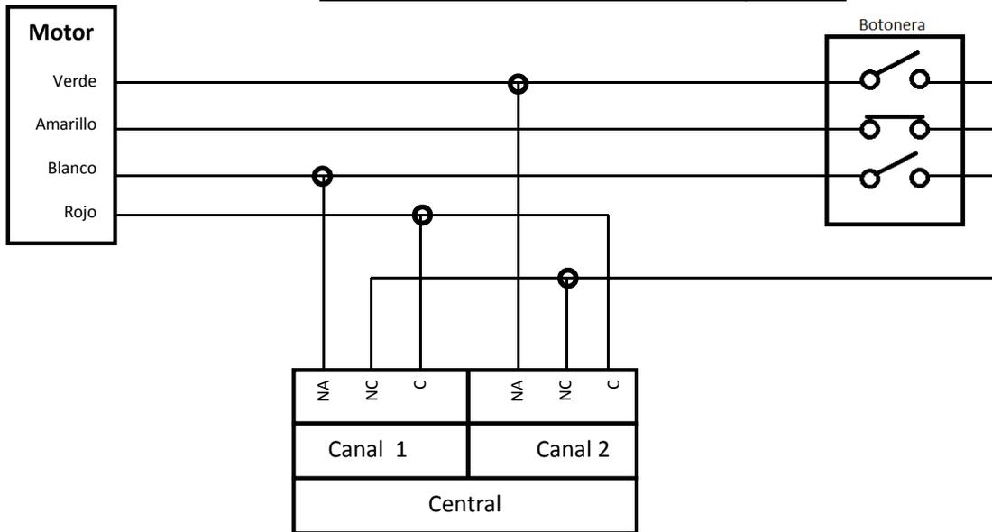
**Conexión de la Central únicamente (cable de botonera):**
